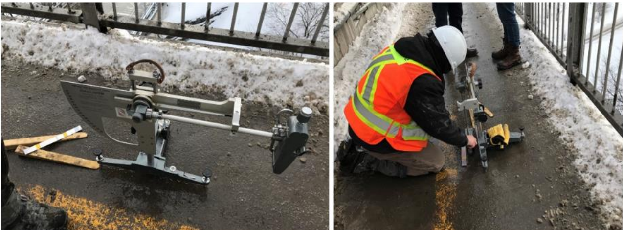
Figure 7 - Tests d'adhérence à l'aide du pendule britannique
