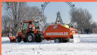
Épandeur à saumure affecté aux pistes cyclables en Autriche
