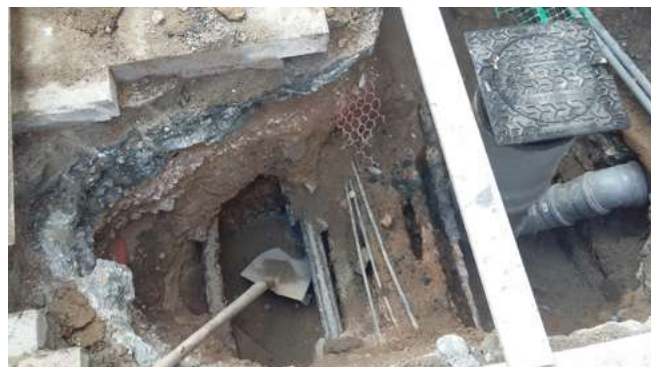
Fosse pédologique ouverte dans un sol urbain dense en réseaux enterrés (électricité, télécoms et eaux). Les différents horizons pédologiques témoignent des forts remaniements du site (2023). / R. Dagois
